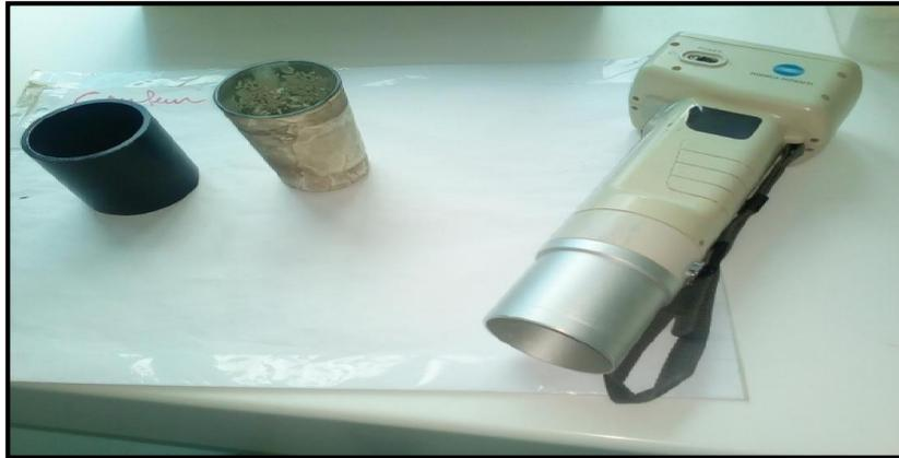
**Figure N°08 :** Matériel utilisé pour déterminer la couleur de matière première
