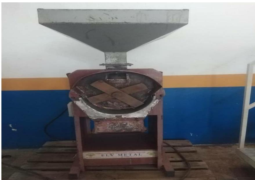
**Fig. N°6 :** Broyeur à marteau.
