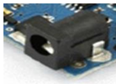
Figure II.4: Entrée de l'alimentation externe pour la carte.
