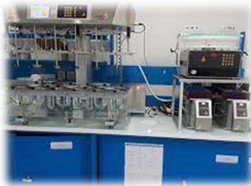
**Figure 54 : Dessolustest : permet de déterminer le taux de la libération du principe actif dans le tube digestif**
