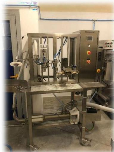
**Figure 18 : Ensacheuse : mise en sachet (conditionnement primaire)**
