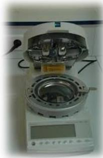
**Figure 44 : Dessiccateur halogène: mesure de la teneur en humidité**
