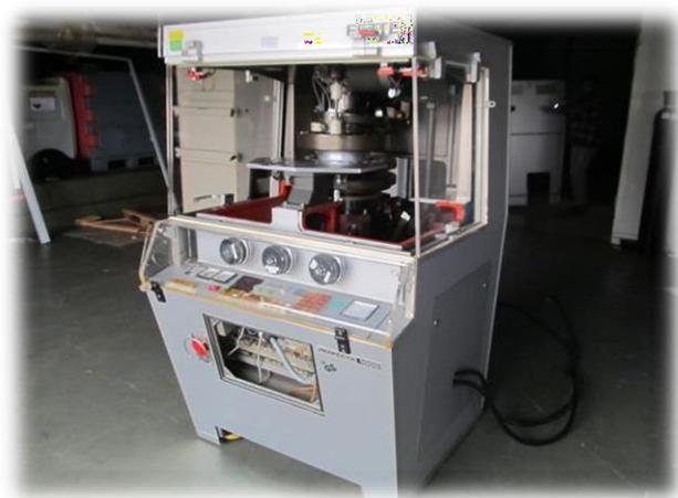
**Figure 15 : Comprimeuse fette (compression)**
