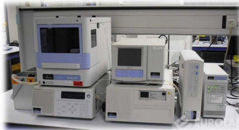
**Figure 50 : HPLC : Identification de substance active**
