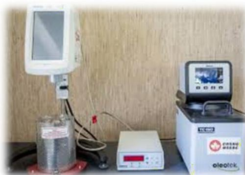
**Figure 52 : Viscosimètre : détermination de la viscosité**
