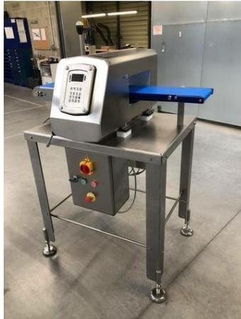
**Figure 16 : Détecteur de métaux : détection des métaux au cours de la compression**
