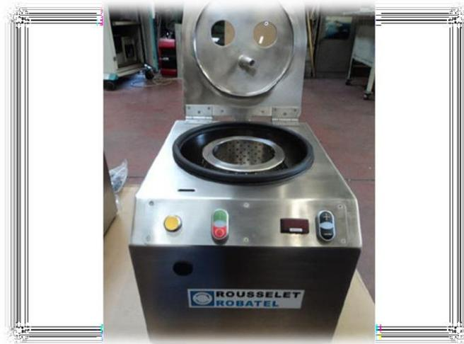
**Figure 56 :Centrifugeuse : séparation des composants**
