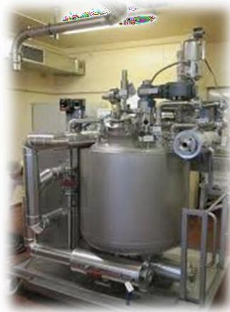
**Figure 19 : Cuve de mélange : préparation de la solution de mouillage**
