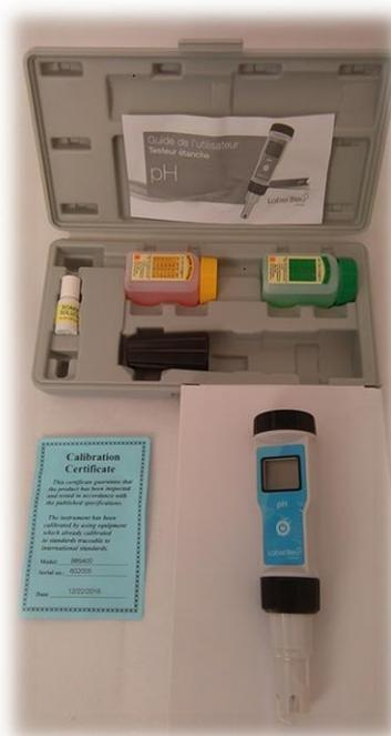
**Figure 55 :pH mètre : mesure de l'acidité**
