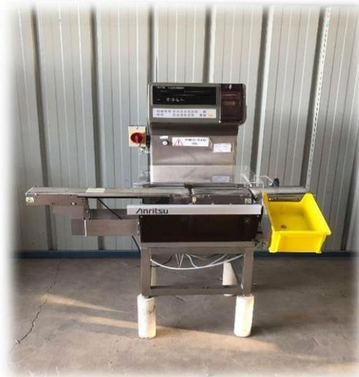
**Figure 17 : Pondérale : control de produit fini au cours du conditionnement**
