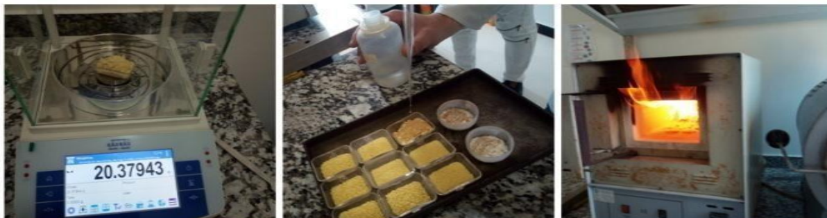
Figure 09. L'analyse de taux de cendre (four à moufle réglable à la température de 550 °C, balance)
