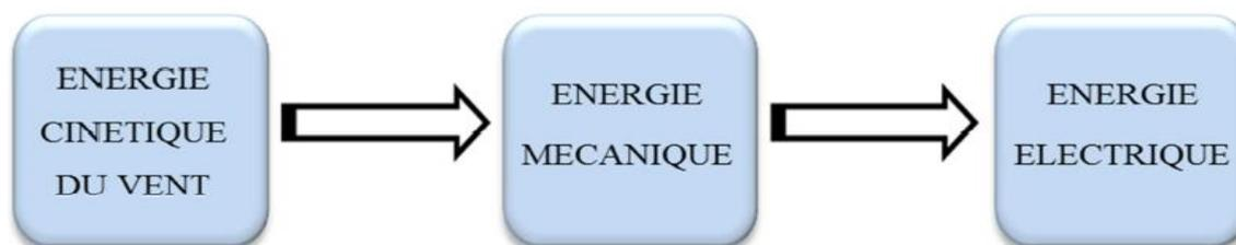
Fig.I.9 : Conversion de l'énergie cinétique du vent.[11]
