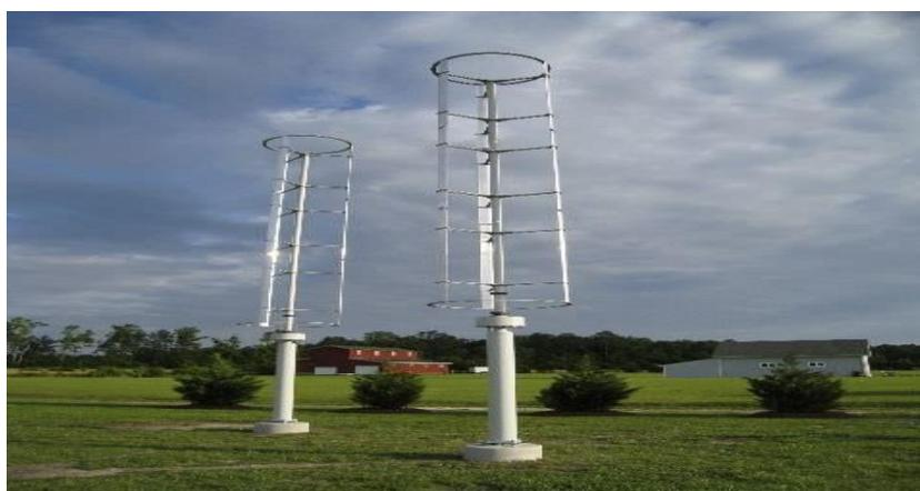
**Fig. I.11** : technologie éolienne à axe vertical.
