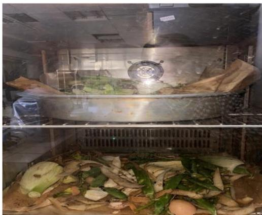
**Figure 10** : Séchage des déchets à l'étuve 70°C
