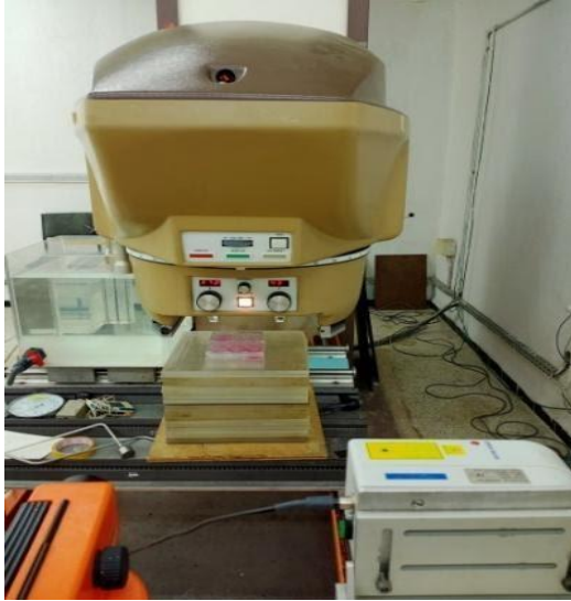
Figure 17: Irradiation des cellules Hep2 par rayonnements gamma à 2Gy (irradiateur ELDORADO-78ACEL Unité de Cobalt 60)
