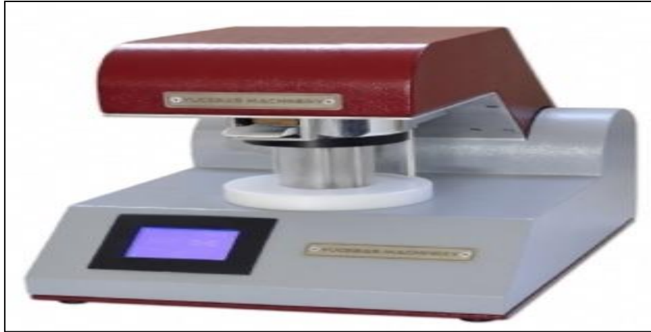
Figure 21 : appareil responsable de l'Amidon d'Endommagement SD MATIC (chopin)
