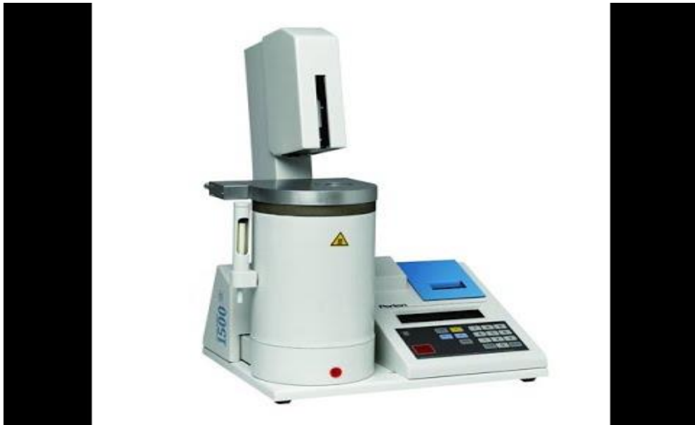
Figure24 : appareil responsable de l'indice de chute (Perten)
