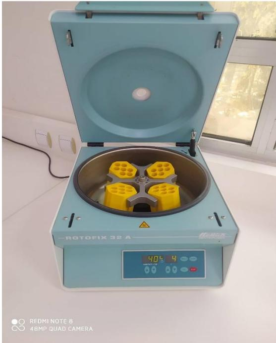
**Figure 1:** Centrifugeuse (Rotorfix 32)
