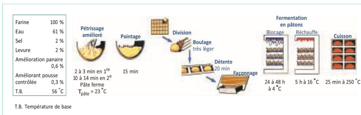
**Figure 7:** Diagramme de fabrication type de la pousse contrôlée bloquée (Langraf, 2002)
