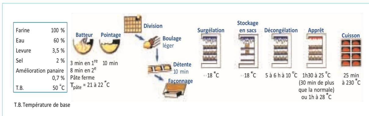
**Figure 9 :** Diagramme de fabrication type de « cru façonné surgelé » (Langraf, 2002)
