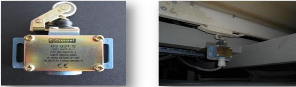
Figure (III.22) : Capteur de position
