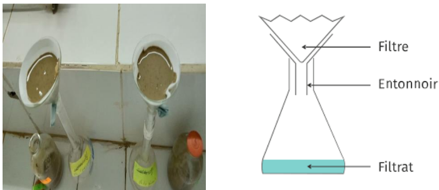
Figure 23 : Filtration de la solution de sol pour la mesure du PH.
