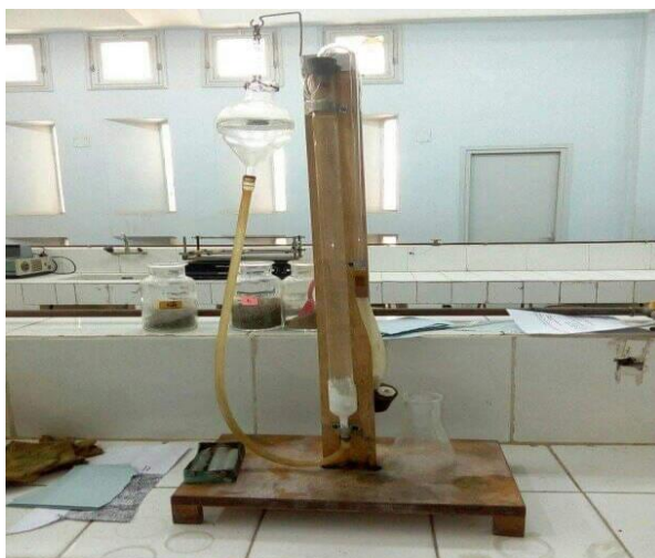
Figure 24 : Calcaimètre de Bernard (photo original)
