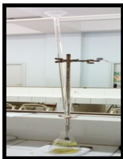
Figure n°32 : les matériels utilisés pour l'analyse de la matière organique a : le balance de précision ; b : les erlenmeyers ; c : la solution H 2 SO 4 ; d : la solution K 2 Cr 2 O 7 ; e : la plaque chauffante ; f : les matériels utilisées pour le titrage ; g : sel de MOHR h : burette + support
