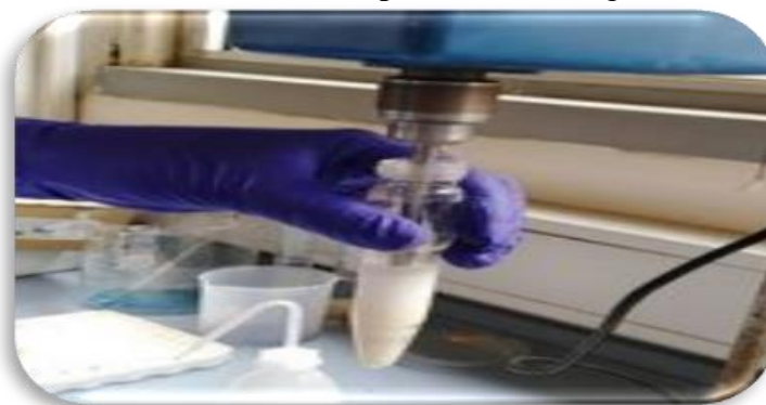
Figure 10: Broyage des échantillons cérébraux à l'aide d'un broyeur homogénéiseur (photo original).
