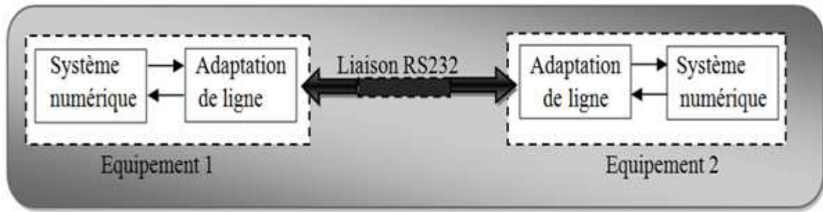
Figure 4.6 : Schéma fonctionnel de la liaison série RS232.
