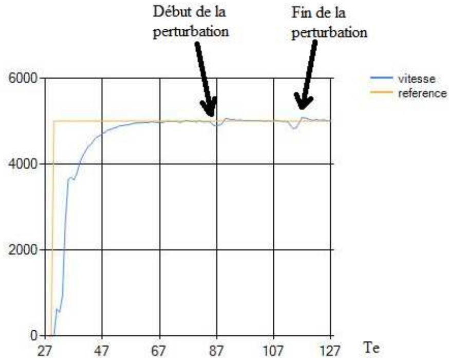
Figure 4.24 : Tracé de la sortie du MCC en présence d'une perturbation en utilisant le PID neuronal.
