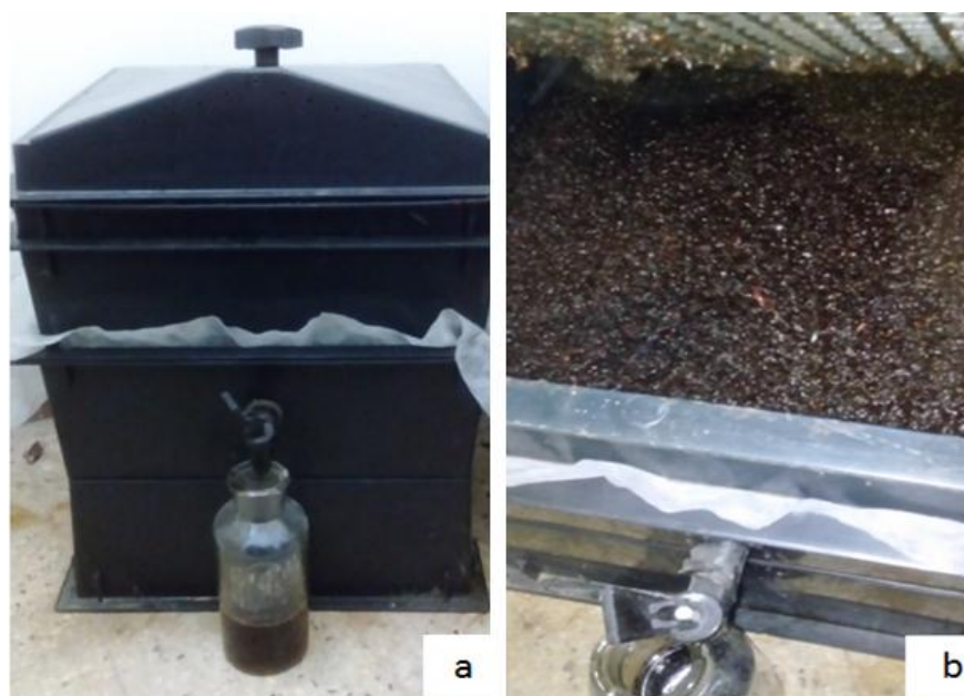
Figure 14 : dispositif d'obtention du jus de lombricompost brut (à : le lombric ; b : les déchets ménagers).
