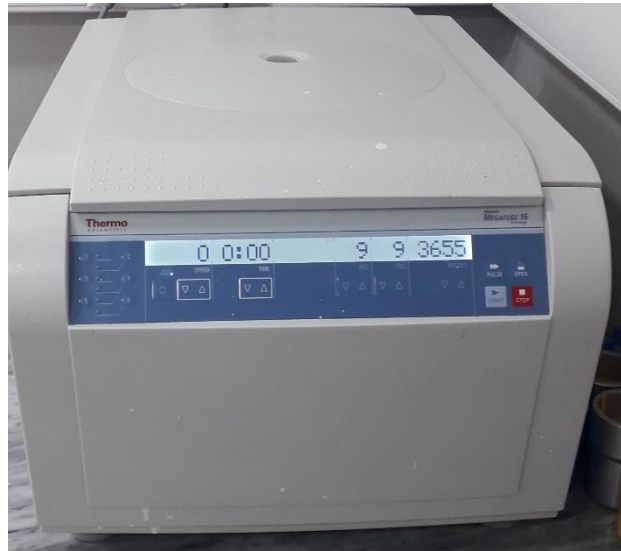
Annexe 2 Centrifugeuse de table Heraeus Megafuge 16 (photo prise au laboratoire central du CAC de Blida)
