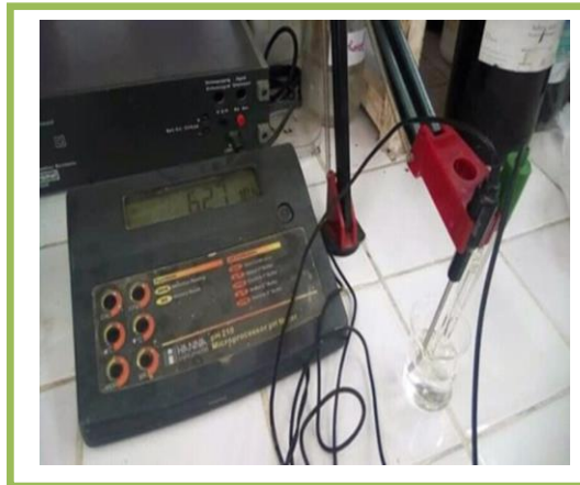
Figure 24 : L'appareillage de mesure de pH
