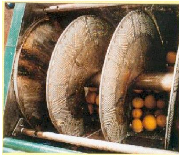
Figure 6 : L'extraction par pression à froid ou expression
