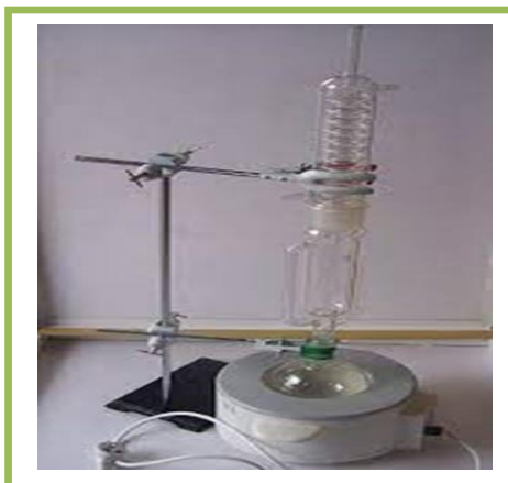
Figure 14 : Dispositif du type : Soxhlet
