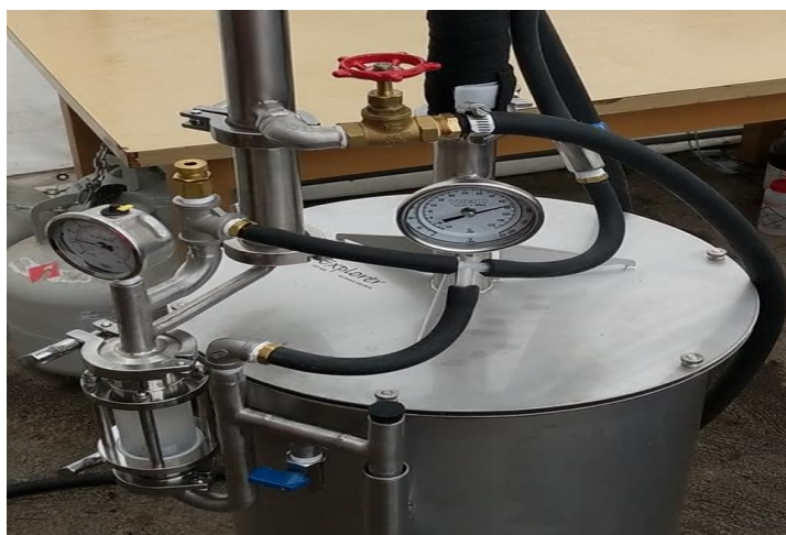
Figure 5 : La distillation par entrainement à la vapeur
