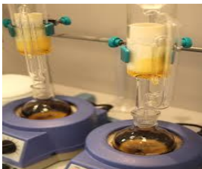
Figure 8 : L'extraction par solvant : de type Soxhlet
