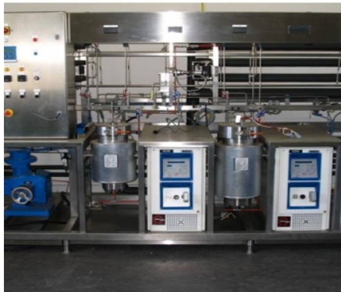
Figure 7 : L'extraction au CO 2 supercritique
