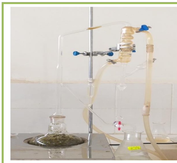
Figure 12 : dispositif du Clevenger
