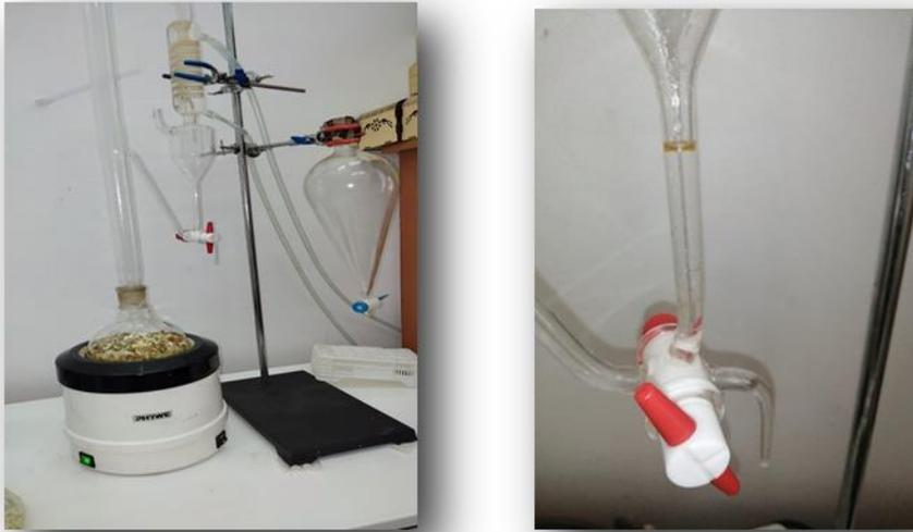
**Figure 19 :** Montage d'hydrodistillation de type Clevenger
