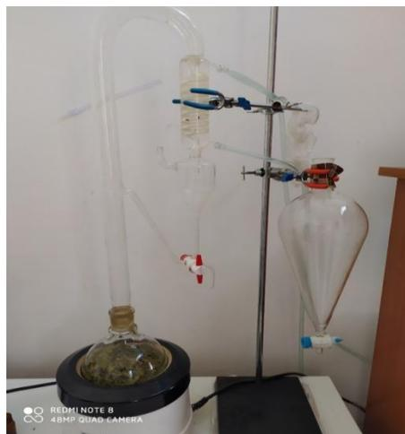
**Appareillage de l'hydro distillation**
