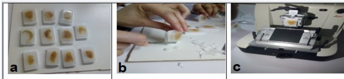
Figure 16 : Coupe au microtome. (a b) : Le dégrossissage s'effectue avec la surface du bloc de paraffine parallèle au plan de coupe. c : Les blocs de paraffine sont solidement fixés sur le porte échantillon du microtome (permet de faire des coupes de 1 à 5 \mu\text{m} d'épaisseur) par l'intermédiaire de la cassette.
