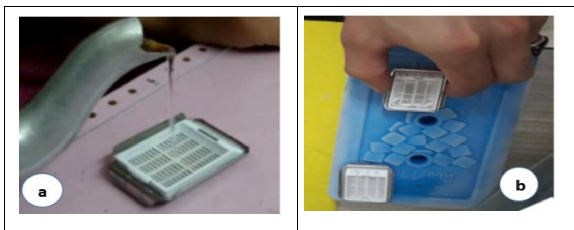
Figure 14 : Etapes de confection des blocs de paraffines. a) Remplissage du moule métallique. b) Mise en place de l'ensemble moule-cassette sur un bain de glace.
