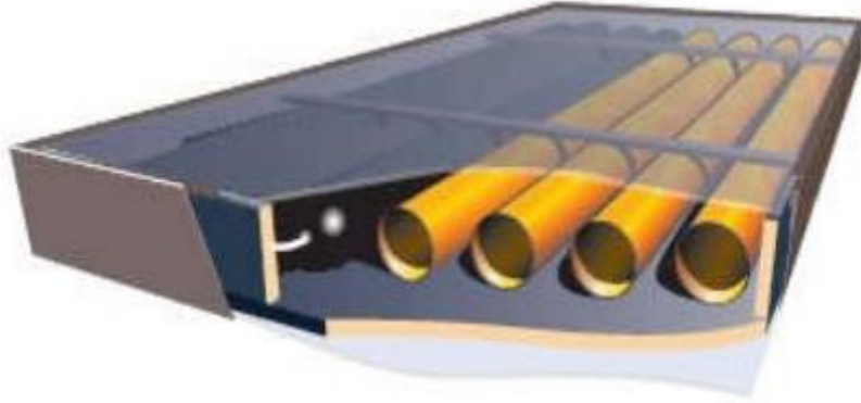
Figure 1.2 coupe d'un capteur solaire thermique plan [4]
