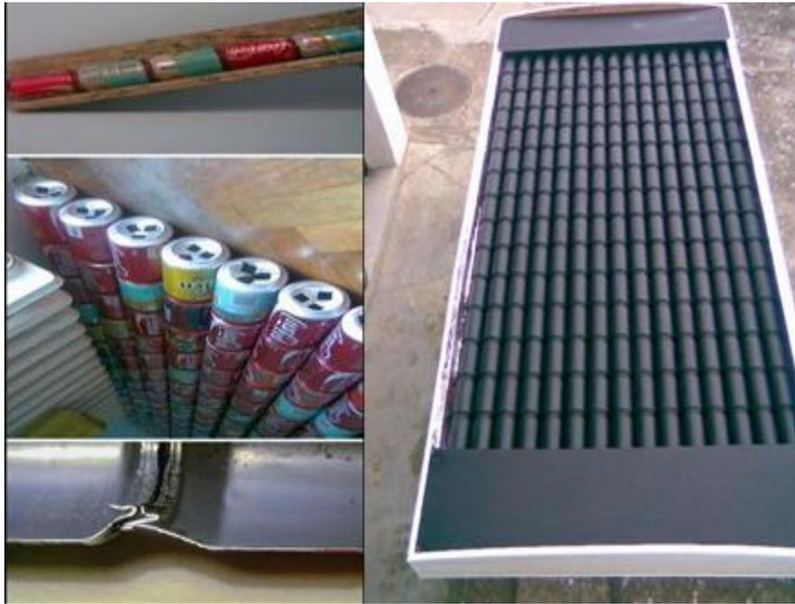
**Figure IV-1** schéma montrant la forme du capteur à canettes de soda
