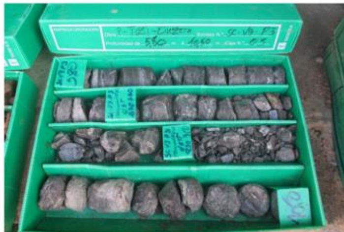
Figure IV. 19: Sondage SCP V8-06 Profondeur 5.80m à 10.50m. [7]
