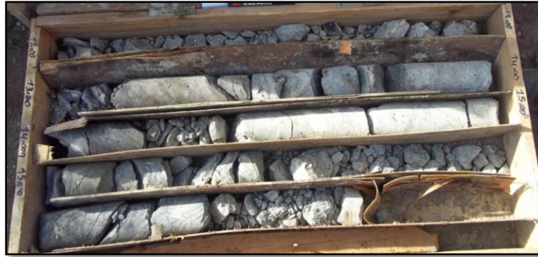
Figure III. 2: SC 42 / caisse 03 de 12.00 à 17.00 m : Schiste gris à niveaux durs [10]
