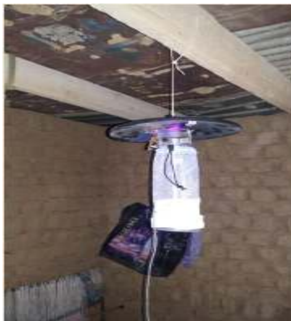
Figure 13 : piège lumineux à UV déposé a l'intérieur d'abris de caprins (photo personnelle 2017)
