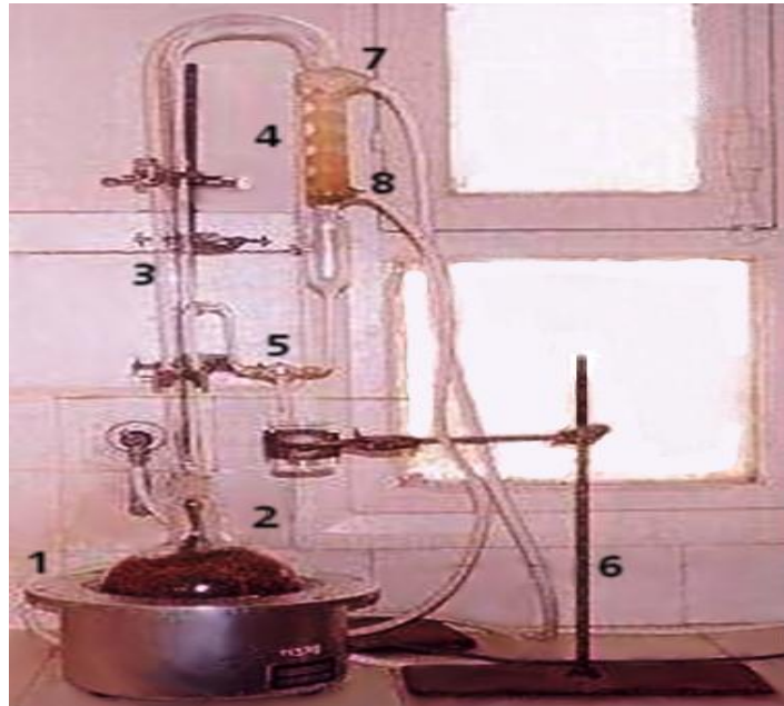
Figure 6 : Montage de l'appareil de Clevenger (1928)
