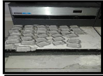
**Figure 42 : le remplissage des moules sur la plaque froide**
