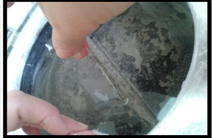
**Figure 45 :L'étalement du ruban sur la lame**
