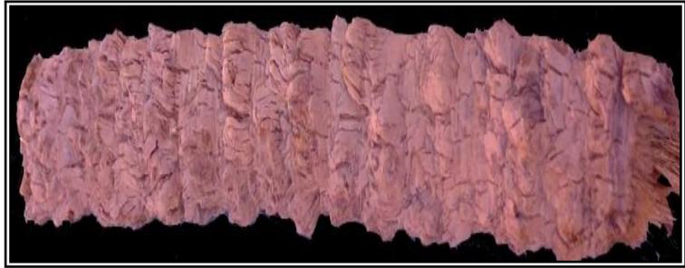
environ. Il peut être aussi découpé en planches assez grossières de 30 à 40 cm de longueur avec une épaisseur de 3 cm pour servir de linteau pour les portes et les fenêtres.
