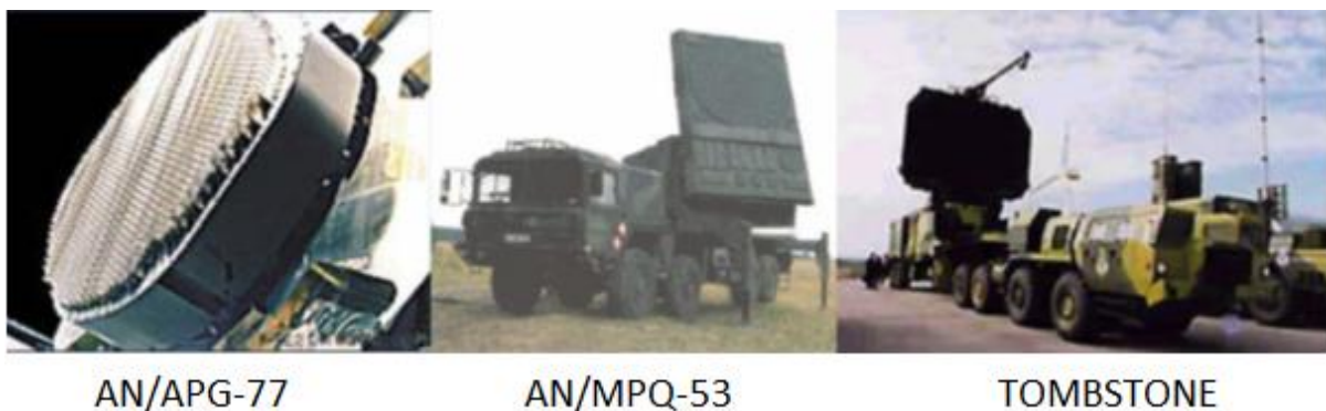
Figure I-2 : exemples des radars qui utilisent des modèles de balayage d'antenne irréguliers
