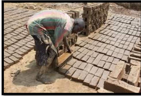
Fig03 : séchage au soleil de la brique de terre.
