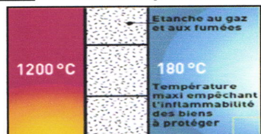
Figure 94: La Résistance au feu du béton cellulaire
