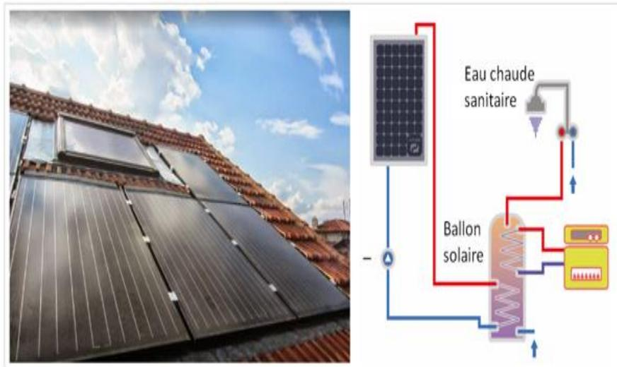
**Figure I.17** : Schéma de principe des panneaux solaires hybrides hydrauliques. [\*]
