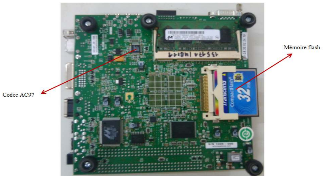
Figure 4.7. La carte ML501 Virtex-5 (Vue d'en dessous).
