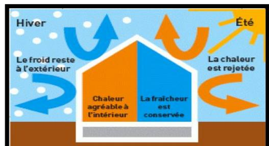
Figure II.69 : Principe de l'inertie thermique dans les saisons
