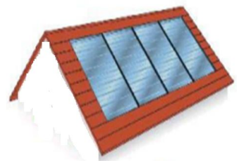
Figure III-27-: le montage intégré du panneau solaire thermique (2)
