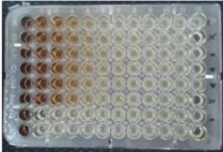
**Figure 17** : la concentration minimale inhibitrice de la croissance de *Staphylococcus Aureus* ATTC 29213 *Escherichia Coli* ATCC 25922 et *Listeria monocytogenes* ATCC 13932 pour une durée d'incubation de 24h à 37°C.
