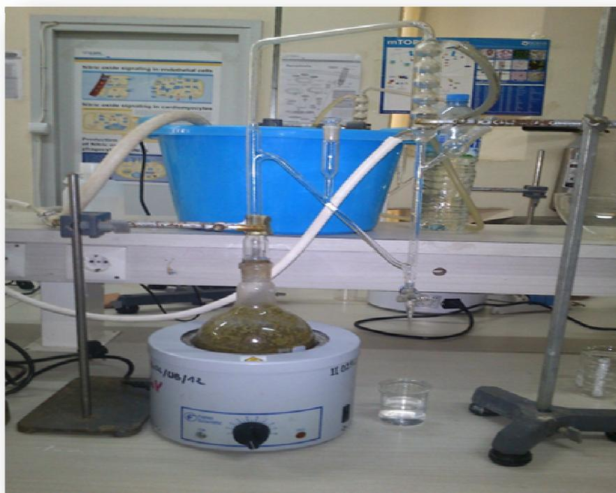
**Figure05 :** Extraction des huiles essentielles par la méthode Clevenger
