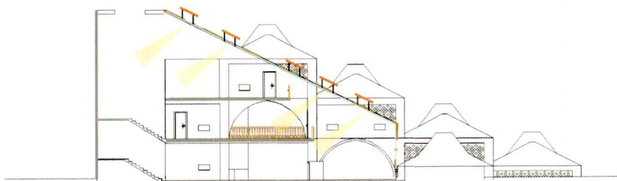
FIGURE 2 SCHEMA REPRESENTANT LES BRISE SOLEIL EXTERIEURS ET L'ECLAIRAGE NATUREL
