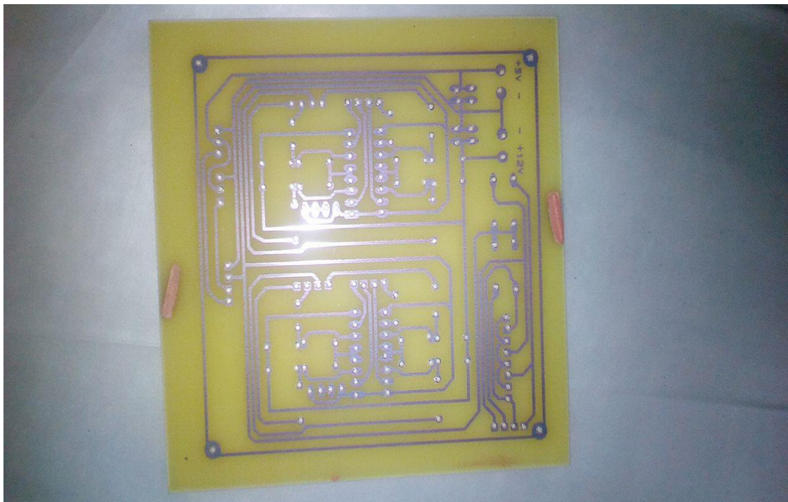
Figure 3-10 : Résultat de la gravure du PCB.
