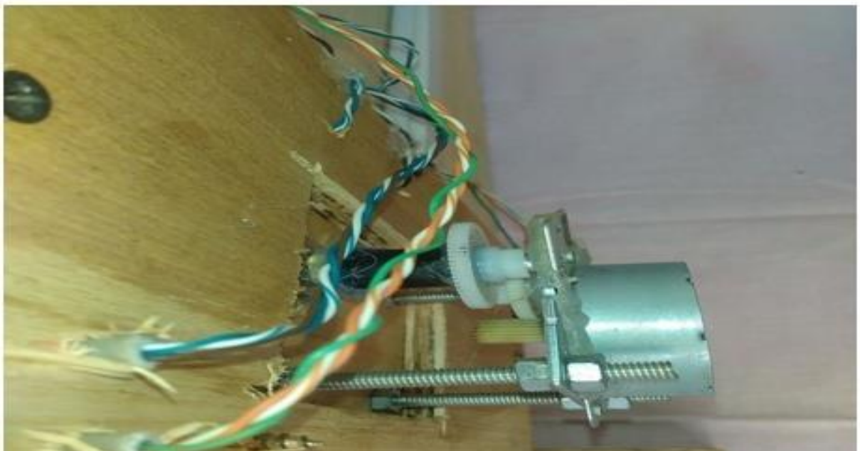
Figure 3-33 : en bas dessous du bras (moteur pas a pas ) en haut le bras avec les trois servo-moteurs.
