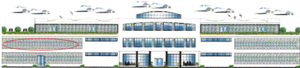
Fig n°57: protection solaire de la façade ouest par moucharabieh
