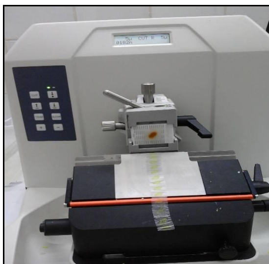
Figure 15 : Confection des coupes par le microtome (photo originale)
