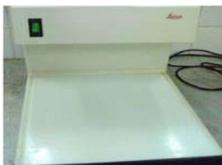
**Figure 24: Platine refroidissante type « Leica »**
