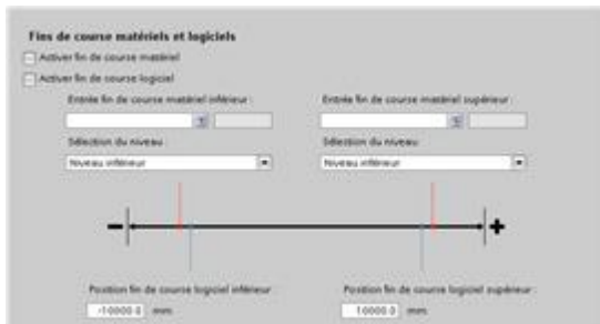
Figure 3.8: configuration des fins de cours matériel et logiciel
