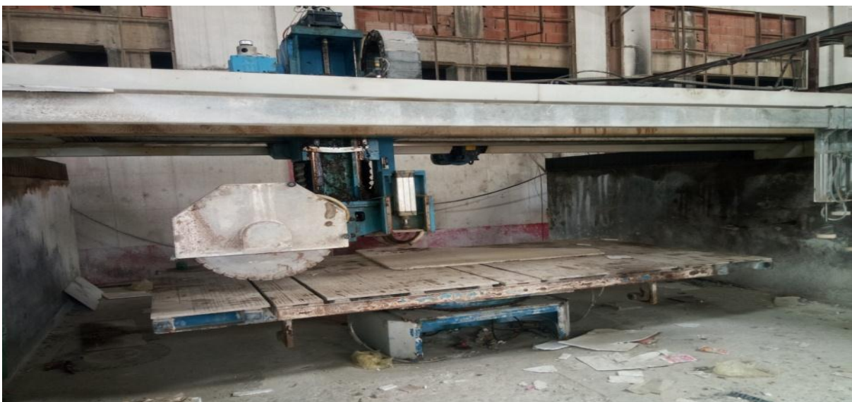
Figure 2.1 : découpeuse de marbre
