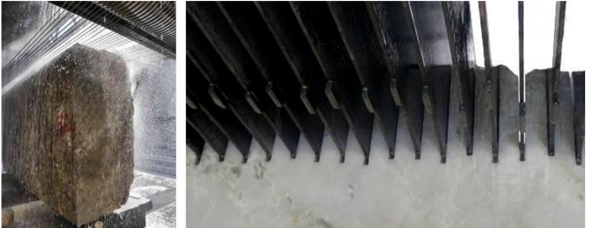
Figure 1.3: transformation de bloc en tranche
