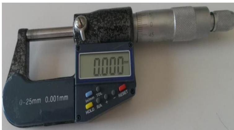
**Photo 22 :** Micromètre électronique.
