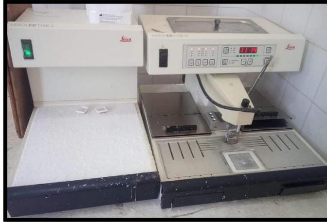
**Figure 34** : appareil de mise en blocs leica + blocs
