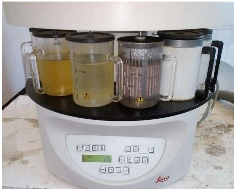
**Figure 8** Automate de déshydratation (Originale)
