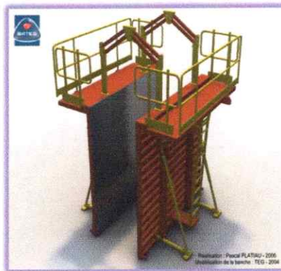
-Fig113. Banches de coffrage-
