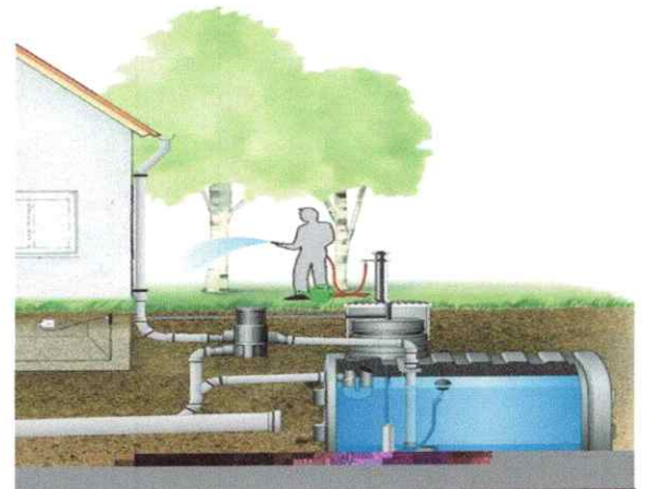
une cuve pour arrosage avec l'eau de pluie
