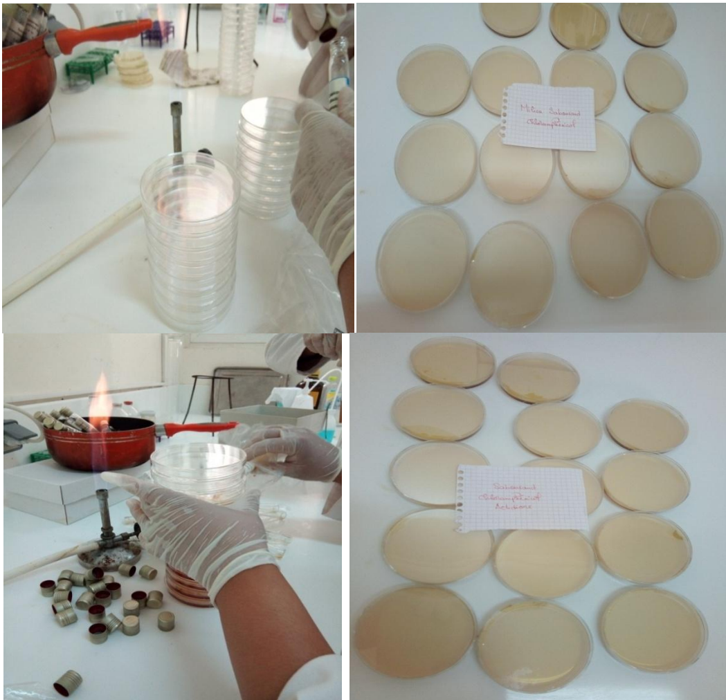
Figure 90: coulage des milieux SC et SAC.
