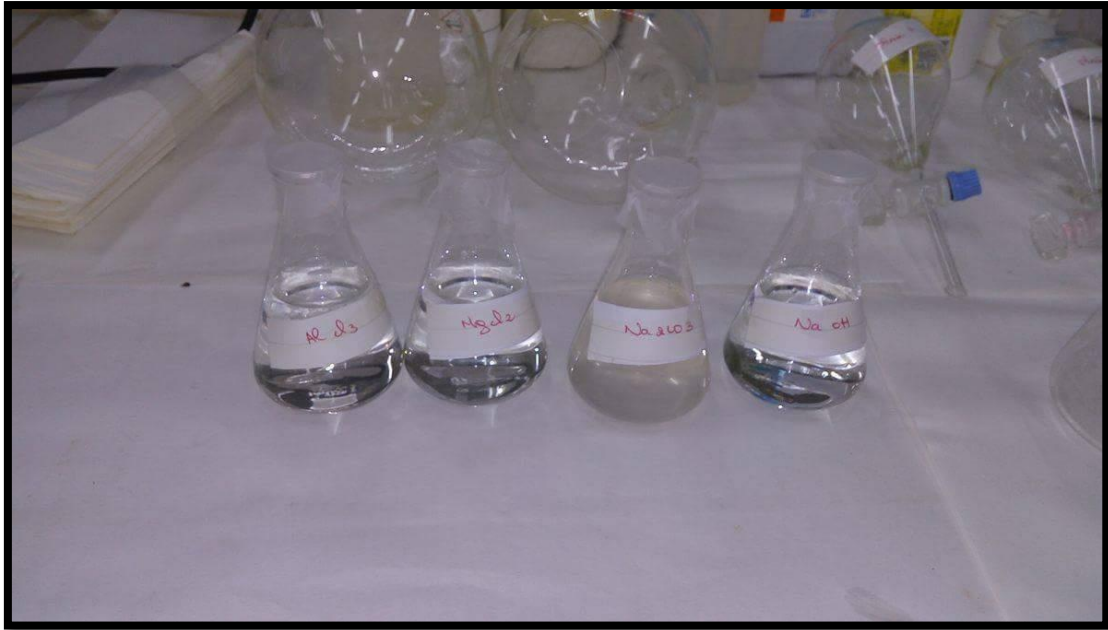
Figure 06 : Les différentes solutions préparées pour la synthèse de Mg-Al-HDL.
