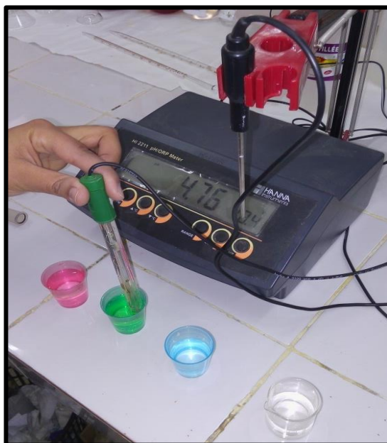
Figure 14 : Etalonnage du pH-mètre.
