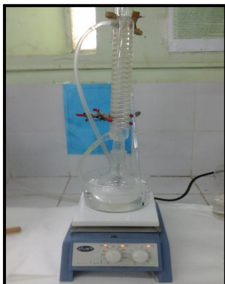
Figure 09 : Chauffage à reflux du mélange réactionnel.
