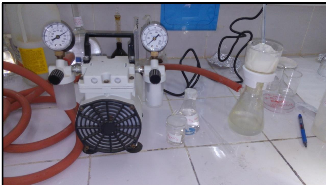
Figure 10 : Filtration sous vide
