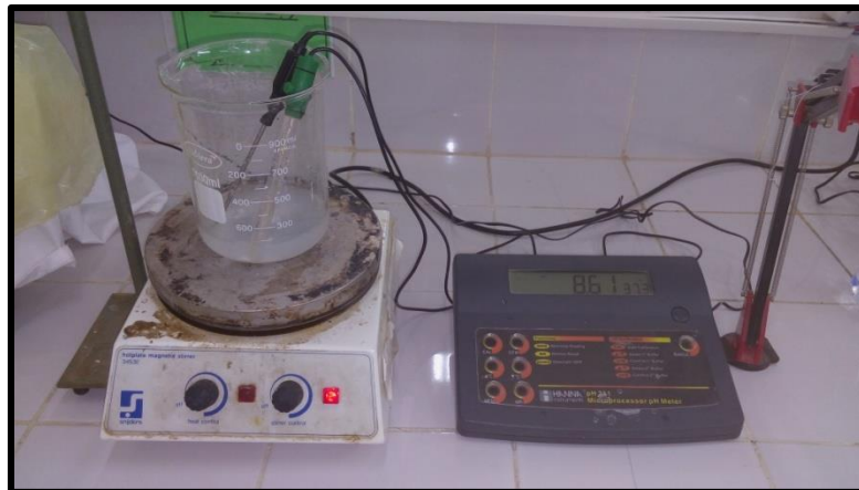
Figure 19 : pH de solution de Mg-Al-HDL préparé.
