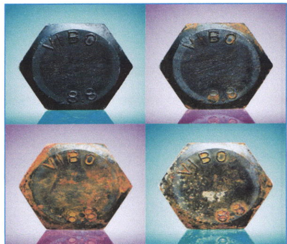
Fig.45 : Eviter l'acier a cause de la corrosion
